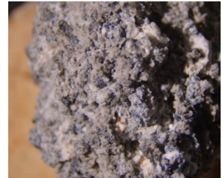
(d) 6101 Alloy foam in \text{MgCl}_2\text{-NaCl}
