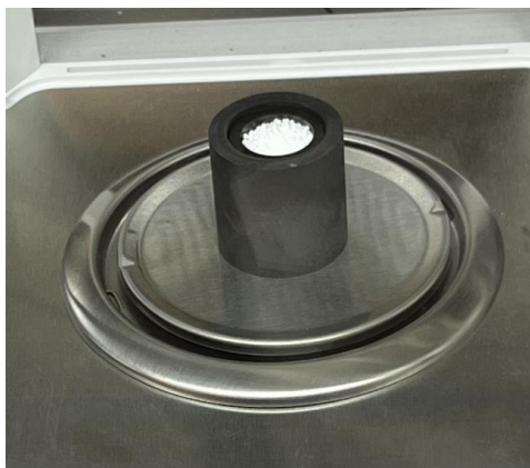
LiCl-KCl eutectic salt loaded
